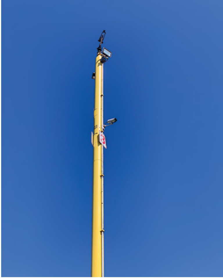
Resim 1. Kuleye Takılan Termal Kamera İle Yeraltı Yangınını Görüntüleme
