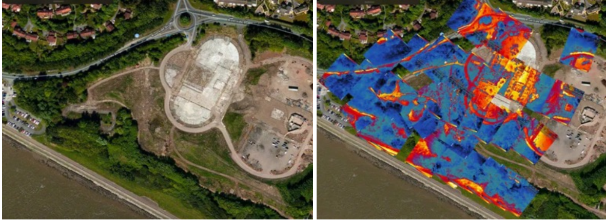
Resim 2. Eski Bir Çöp Depolama Alanında Termal Görüntüleme
