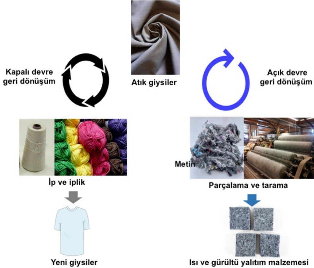
Şekil 8-4. Tekstillerin Kapalı ve Açık Devre Mekanik Geri Dönüşümü.
