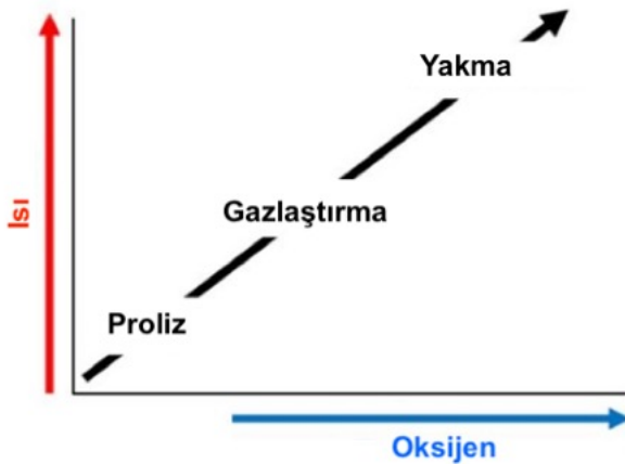
Şekil 7-2: Isı ve Oksijene Bağlı Olarak Termal Dönüşüm
