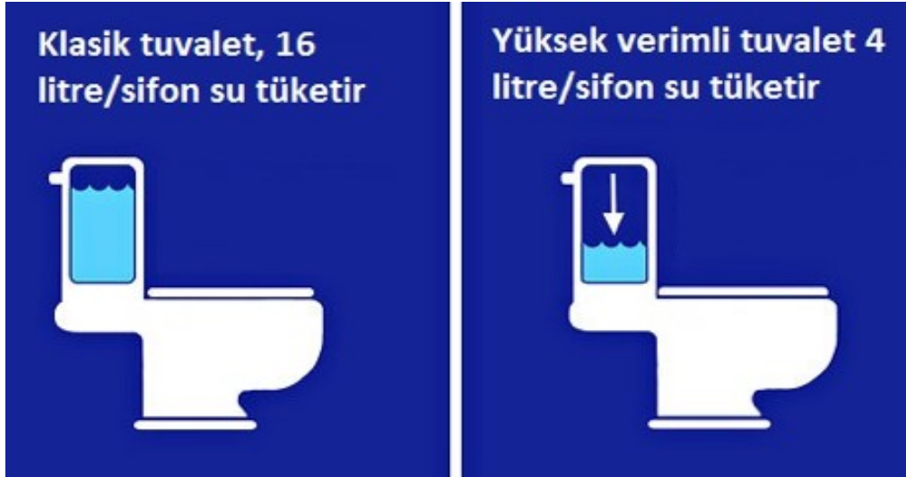
Şekil 17. Klasik Tuvalet Rezervuarı ile Yüksek Verimli Tuvalet Rezervuarı
