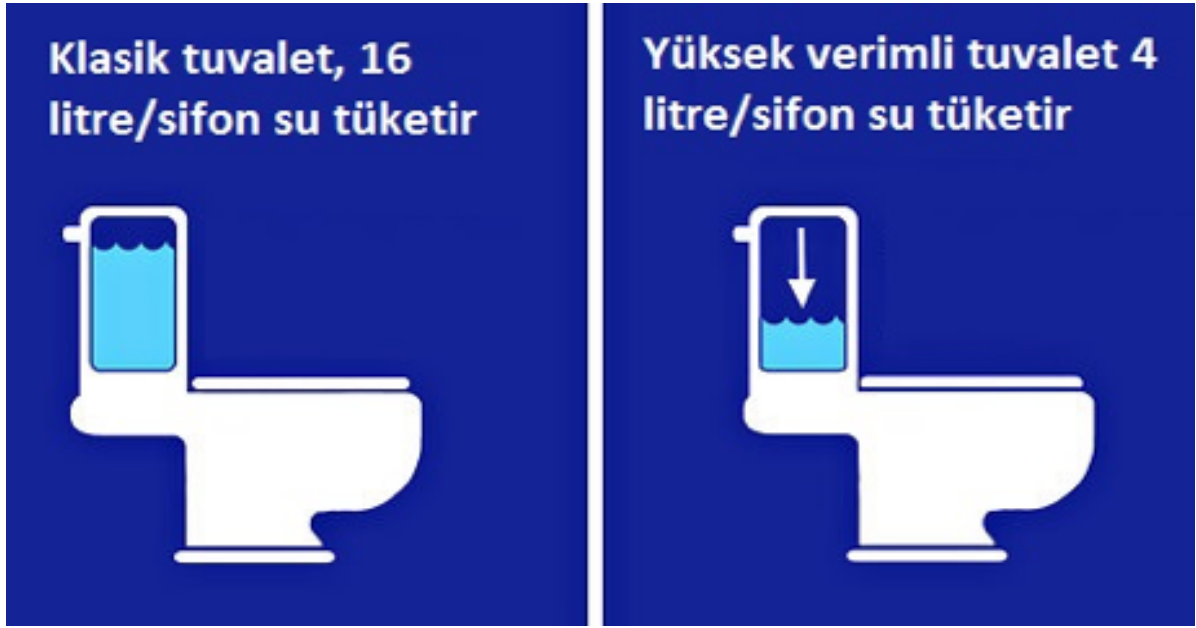
Şekil 7. Klasik Tuvalet Rezervuarı ile Yüksek Verimli Tuvalet Rezervuarı
