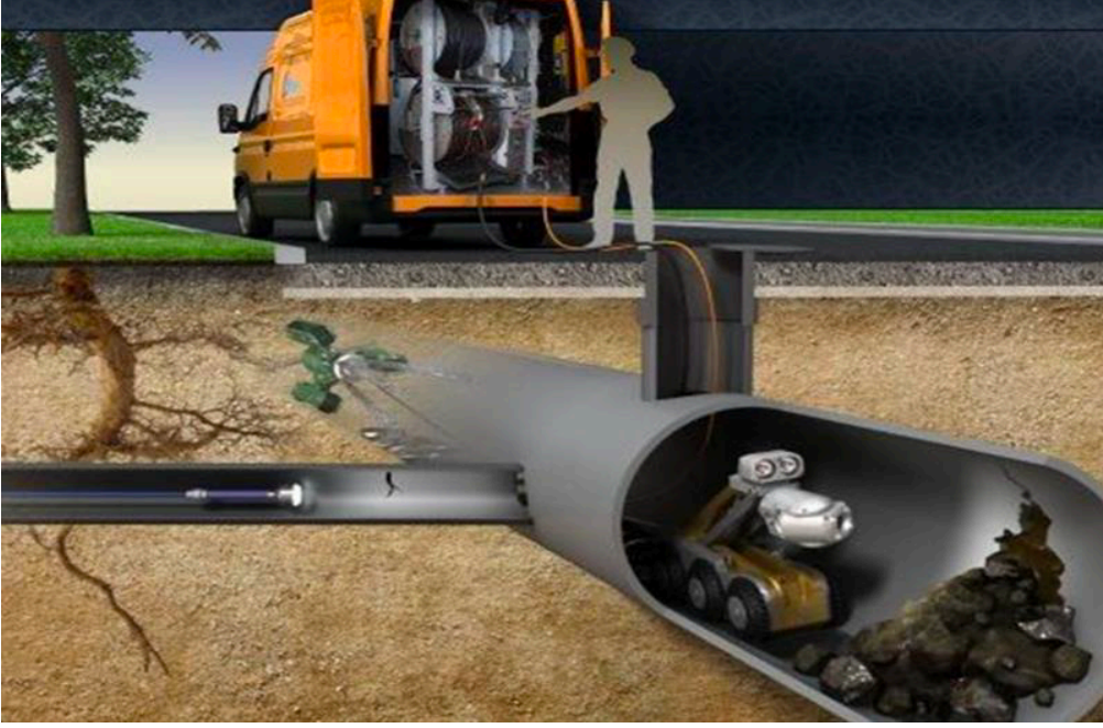
Şekil 3.1. Kanalizasyon Görüntüleme Robotu ile Kanalizasyon İzleme Çalışması
