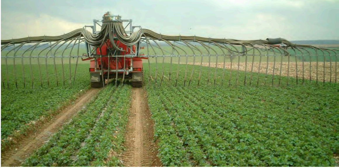
Ŗekil 35. rmŖ Sıvı Hayvan Gbresinin Topraęa Enjeksiyonlanması
