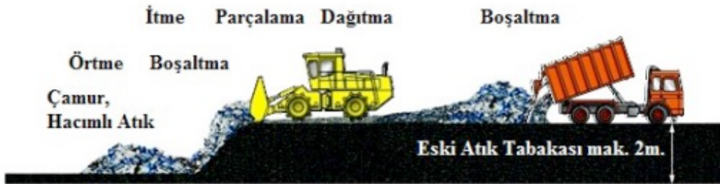
Şekil 3-6. Çukura Atık Boşaltma Uygulaması
