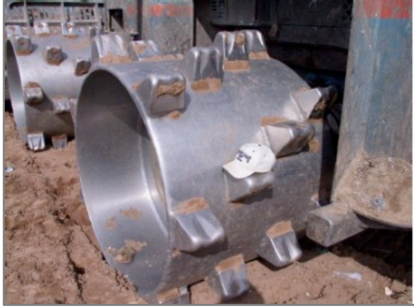
Şekil 5-1. Kompaktör Tekerleği ve Atığı Parçalamak için Dişliler
