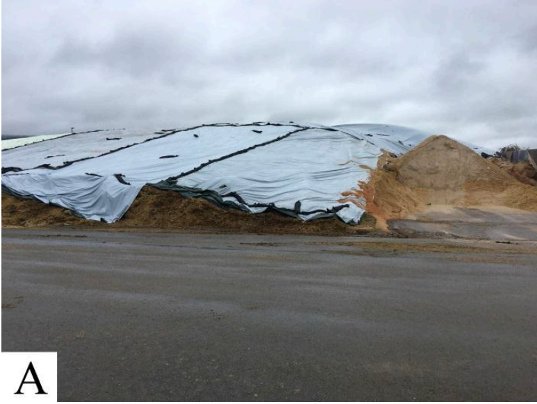
Şekil 2. Biyogaz Tesisi Üzeri Kapalı Biyokütle Yığını (A) veya Traktör Tarafından Beton Bunker Silosunda Preslenmiş Biyokütle (B)
