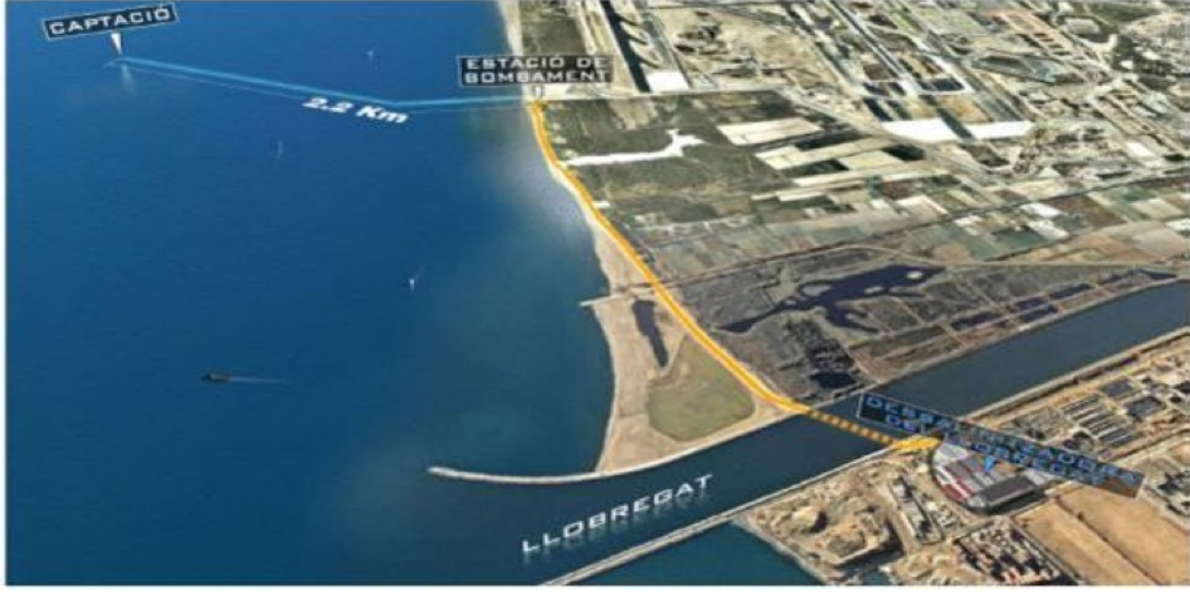
Şekil 4: Barselona’da Deniz Suyu Alma Yapısı
