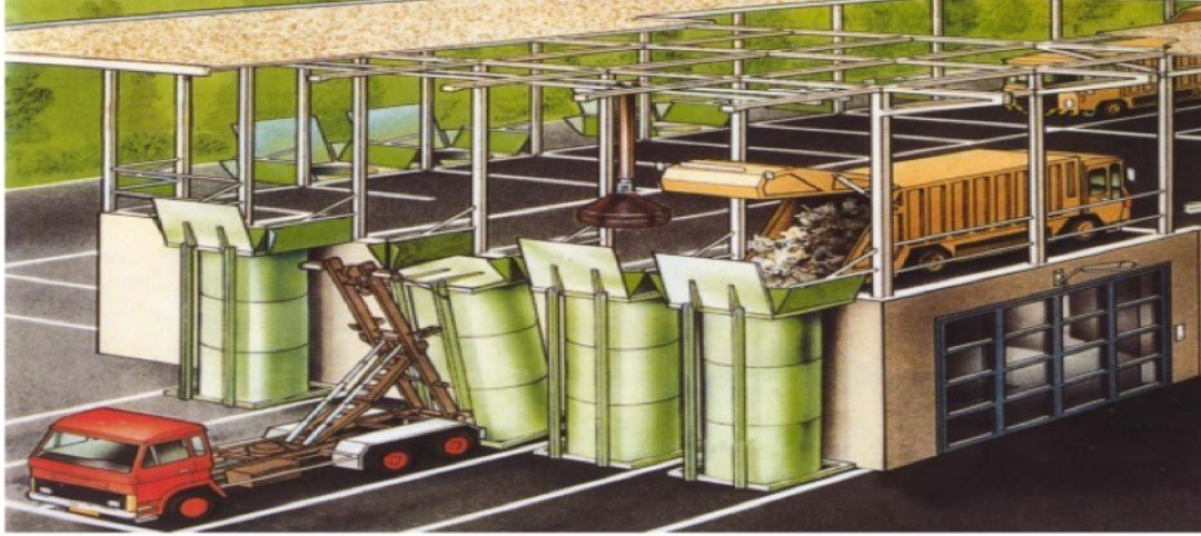
Şekil 8 Aktarma istasyonu ve çalışma şekli
