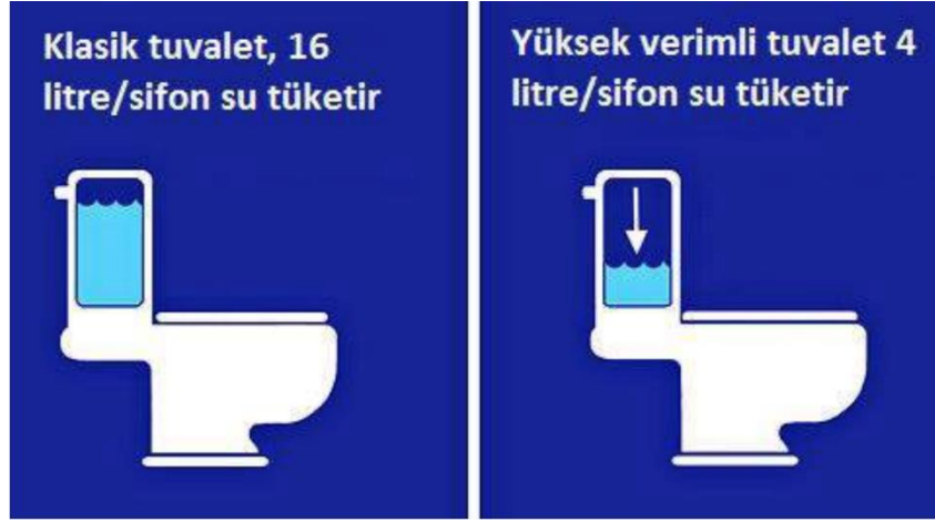
Şekil 3-3 Klasik Tuvalet Rezervuarı ile Çift Yıkama Seçenekli Yüksek Verimli Tuvalet Rezervuarı
